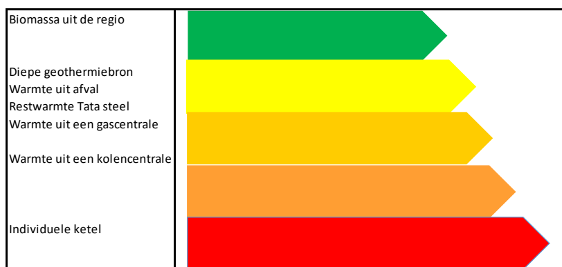
Figuur 2: Warmteladder voor MRA op systeemniveau
